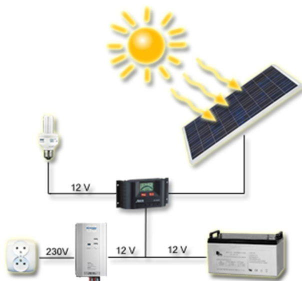
Schemat 9. Schemat pracy systemu fotowoltaicznego
