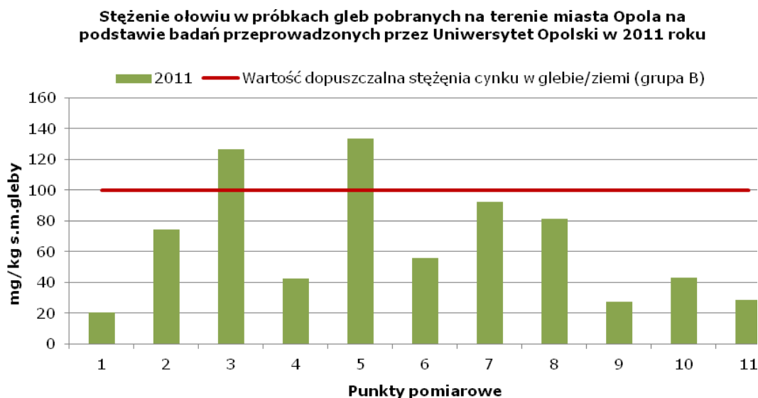
Rysunek 41. Zawartość ołowiu w próbkach gleb na badanych obszarach z wartością graniczną dla gleb w grupie B (100 mg/kg s.m. gleby), w 2011 r. (opracowanie własne ATMOTERM S.A.).
