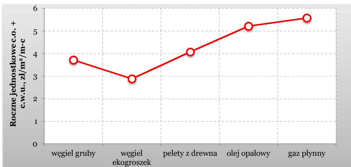
Rys. 5. Zestawienie kosztów jednostkowych na c.o. i c.w.u. w zależności od nośnika energii na terenie gminy Leśnica – nośniki pozasystemowe
