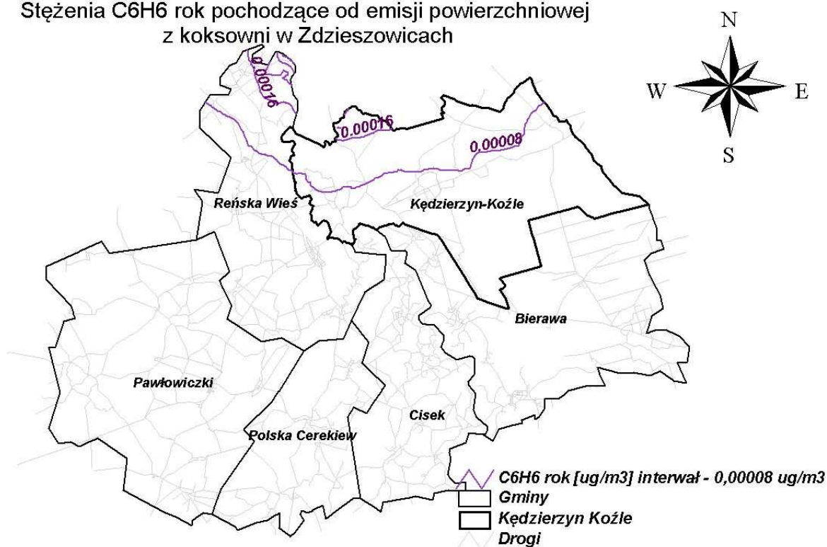
Rysunek 138 Stężenia benzenu o okresie uśredniania wyników pomiarów rok kalendarzowy w powiecie kędzierzyńsko-kozielskim pochodzące od emisji powierzchniowej z pasa 30 km od powiatu (dane z Koksowni Zdieszowice) w 2005 r.
