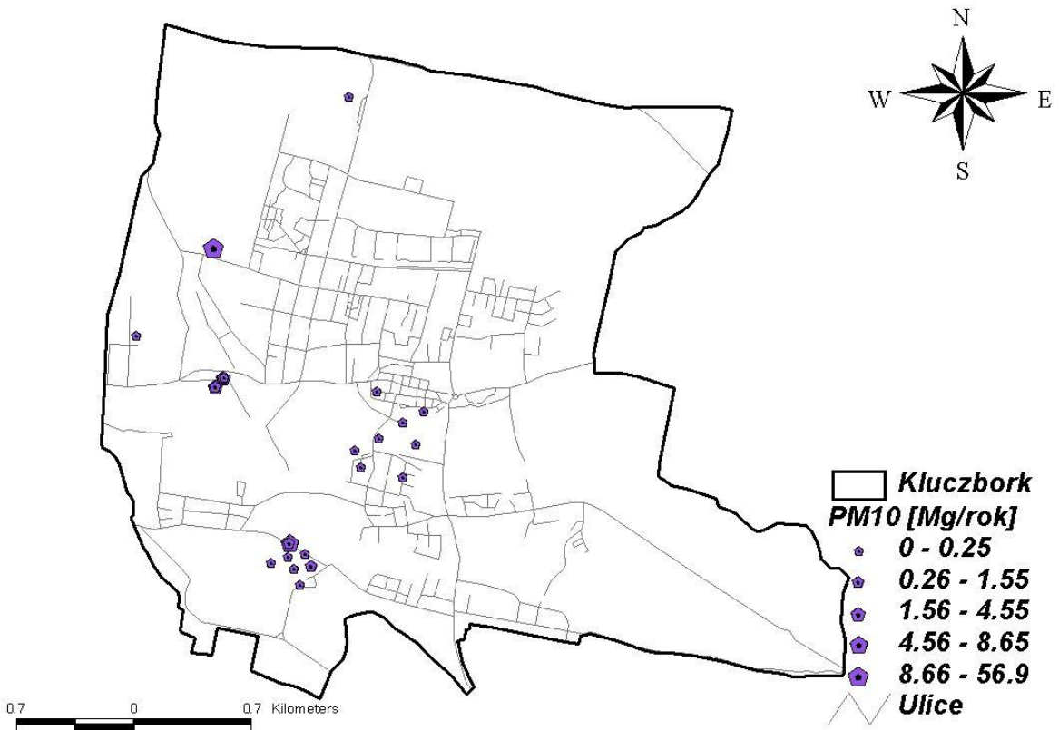
Rysunek 44 Emisja punktowa pyłu zawieszonego PM 10 z emitorów punktowych na terenie Kluczborka w 2006 r.
