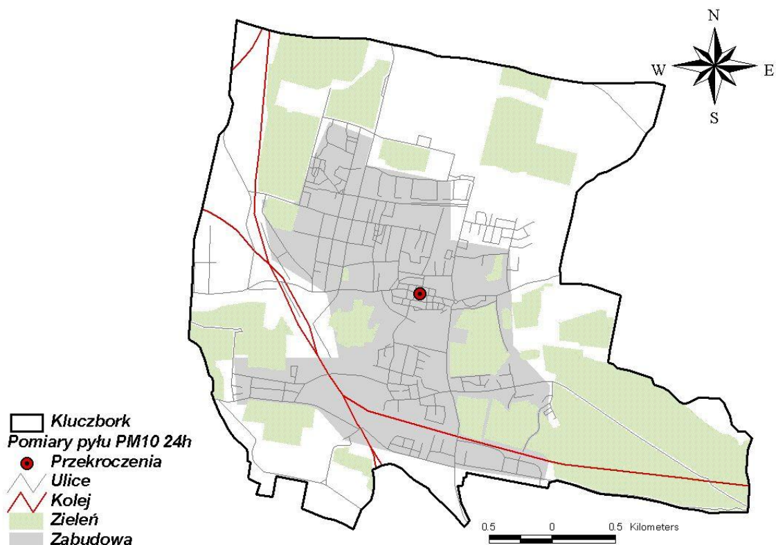
Rysunek 3 Przekroczenia poziomu dopuszczalnego pyłu zawieszonego PM 10 o okresie uśredniania wyników pomiarów 24 godziny na stacji wyznaczonej przez WIOŚ do oceny rocznej w Kluczborku w 2006 r.
