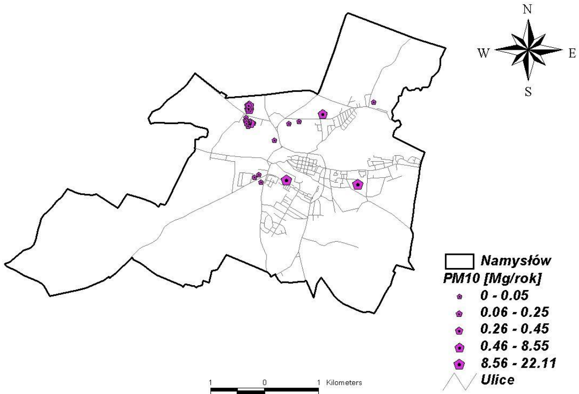
Rysunek 42 Emisja punktowa pyłu zawieszonego PM 10 z emitorów punktowych na terenie Namysłowa w 2006 r.
