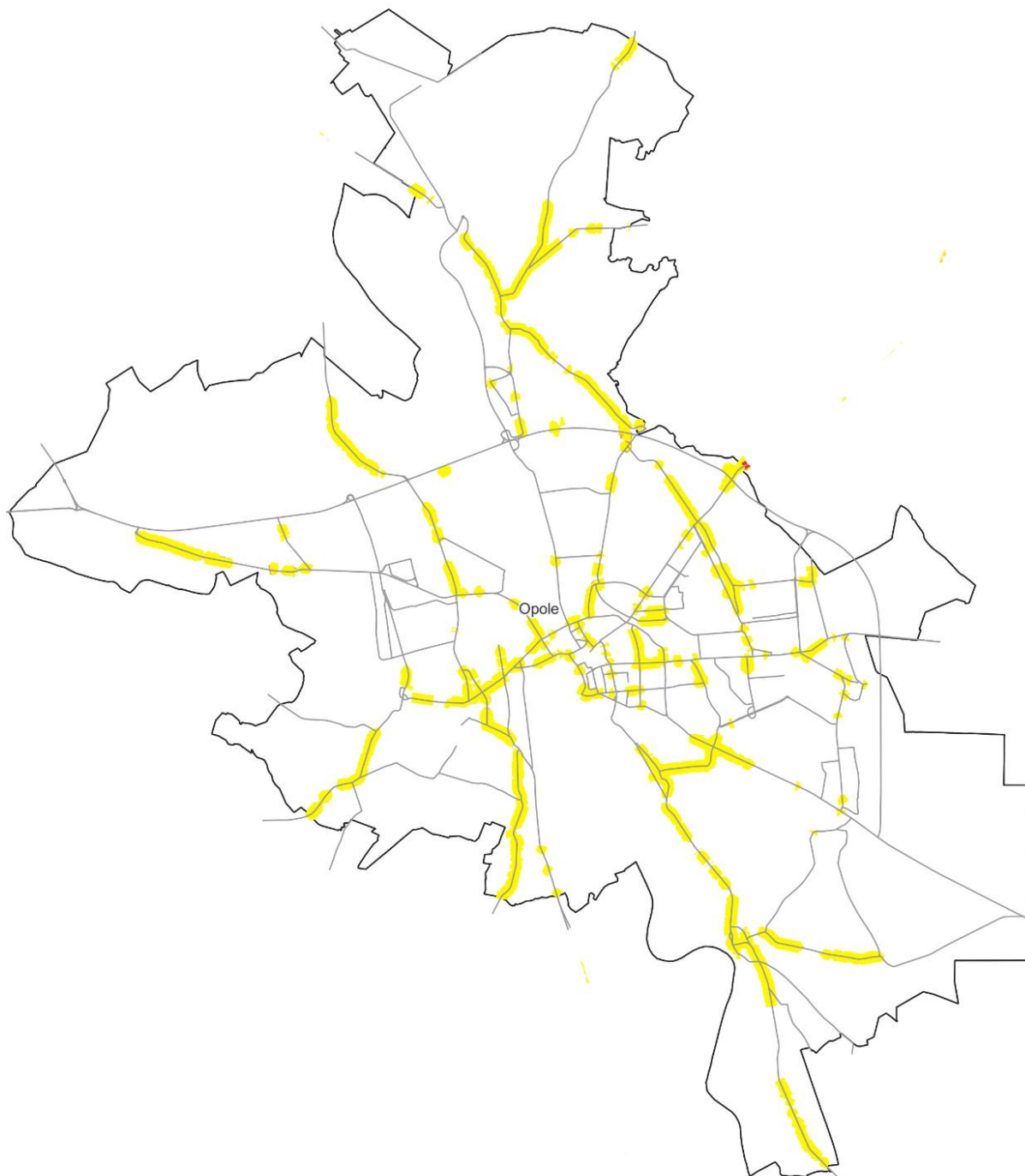
Rysunek 2-2 Usytuowanie terenów zagrożonych hałasem drogowym w zakresie 5-10 dB w granicach miasta Opola.
