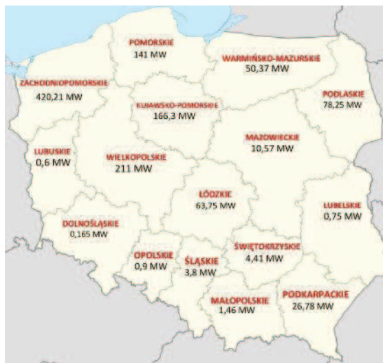
Rys. 4. Rozmieszczenie i moce elektrowni wiatrowych w Polsce – stan na maj 2011 (wg. PSEW, na podstawie danych Urzędu Regulacji Energetyki - URE)
